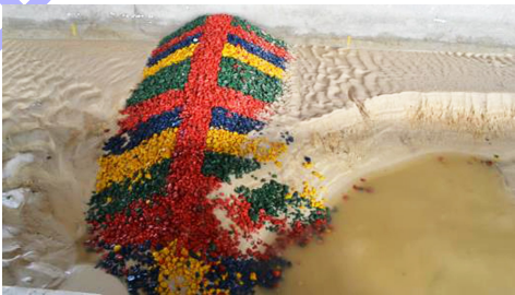
图 2 水槽试验丁坝水毁破坏形式
