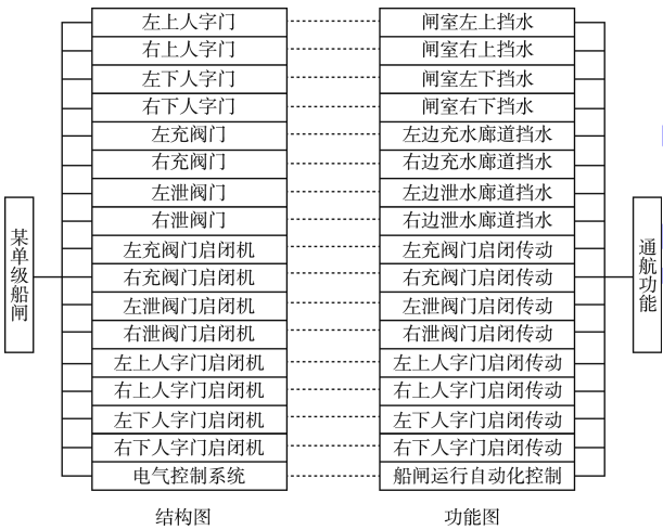
图 1 某单级船闸功能结构简图
