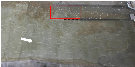
图 3 风光枢纽上游口门区水流流态
