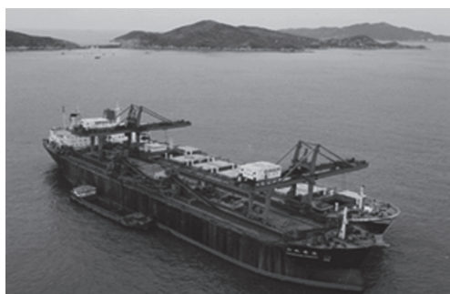
图1 “新双峰海”号海上减载转运系统在作业中
