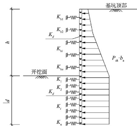
注:  $K_{h1}$ 、 $K_{h2}$ 、…… $K_{hn}$ 、 $K_{l1}$ 、 $K_{l2}$ 、…… $K_{ln}$ 为支撑刚度;  $K_d$ 为地墙环向刚度
