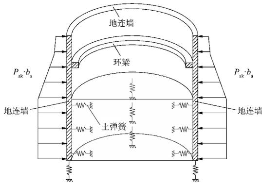
图2 空间弹性地基板法分析模型
