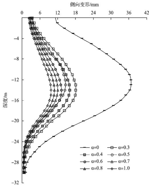
图 4 地连墙侧向变形曲线
