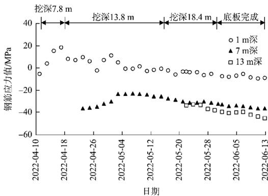
图 10 地连墙水平向钢筋平均应力历时曲线
