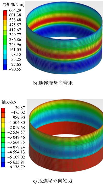
图 6  $\alpha$  值为 0.5 工况下模型非线性静力计算结果
