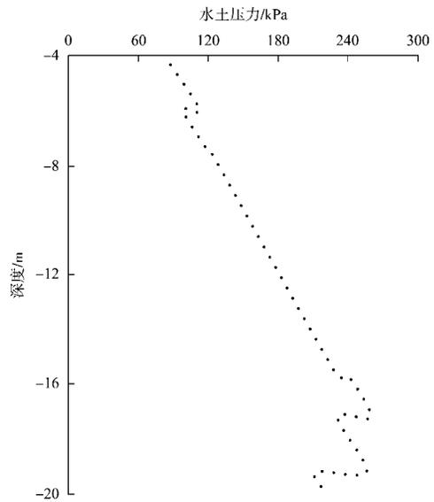
图 5 墙后静止水土压力计算值分布
